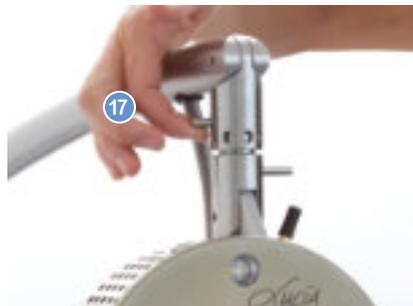
Durch leichtes Drehen des Lampenkopfes im Uhrzeigersinn gleitet dieser aus der Haltevorrichtung nach unten. Achtung der Lampenkopf ist ca. 2,2 Kilogramm schwer.
