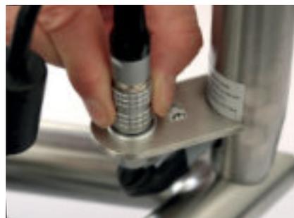
Zum Abbau des Lampenkopfs den Kopf in die gezeigte Position bringen. Mit einer Hand den Kopf gegen Herunterfallen sichern und mit der anderen Hand den Entriegelungsstift **17** hochdrücken.
