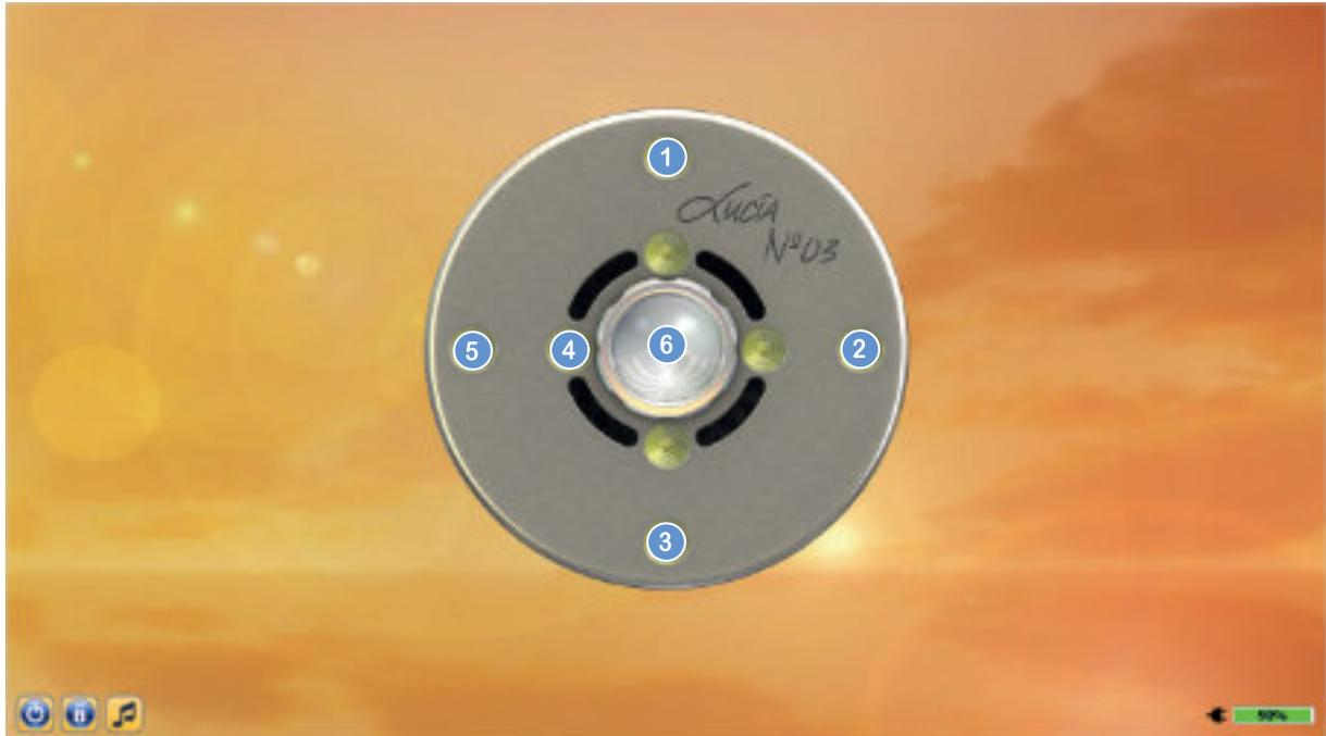
Die Halogenlampe ⑥ in der Mitte der Lampenkopf-Abbildung zeigt an, ob die Lucia N°03 mit dem Laptop verbunden ist: Ist die Halogenlampe schwarz, muss die Lucia N°03 erst verbunden werden (siehe “Der Lucia N°03 Laptop” > “Aufbau einer Bluetooth-Verbindung”), leuchtet sie hingegen – wie oben abgebildet –, besteht bereits eine Verbindung.
