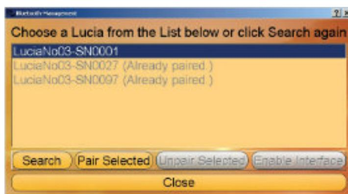
Klicken Sie das Gerät an, das gepaired werden soll. Wählen Sie **Pair Selected**. Wenn der Vorgang beendet ist, gehen Sie auf **Close**. Das Pairing zwischen der Lucia N°03 und Ihrem Laptop ist nun erfolgreich abgeschlossen und im Normalfall wird daraufhin automatisch eine Verbindung aufgebaut (andernfalls siehe „Der Lucia N°03 Laptop“ > „Aufbau einer Bluetooth-Verbindung“).
