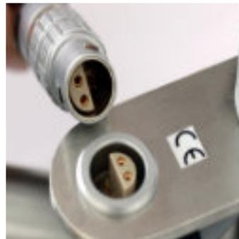
Jetzt können Sie das Netzteil mit dem Kabel **7** an das Stromnetz anschließen. Die LED´s blitzen kurz auf – somit ist das Gerät betriebsbereit und kann über den Lucia N°03 Laptop gesteuert werden.
